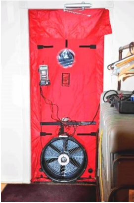
The blower door apparatus
